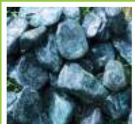
Galets décoratifs arrondis, lavés et secs, prêt à être mélangé à la résine PAVILAND et à granulométrie contrôlée optimale, pour la réalisation de trottoirs fonctionnels et décoratifs.
